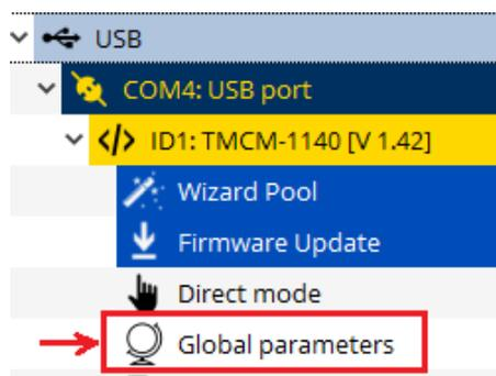
Dans la fenêtre qui apparaît, configurez les trois paramètres "**69 - CAN Bitrate**", "**70 - CAN Send Id**" et "**71 - CAN Receive Id**". Dans cet exemple, la vitesse CAN est configurée à 1Mbps et l'ID CAN sur 1. Double-cliquez sur les champs concernés pour pouvoir modifier les valeurs.
