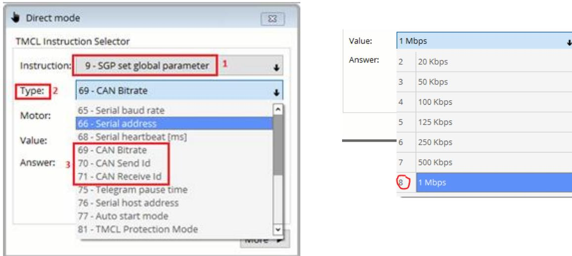
"69 - CAN Bitrate" configure la vitesse du bus CAN. Utiliser la valeur 8 pour une vitesse de 1 MBps.
