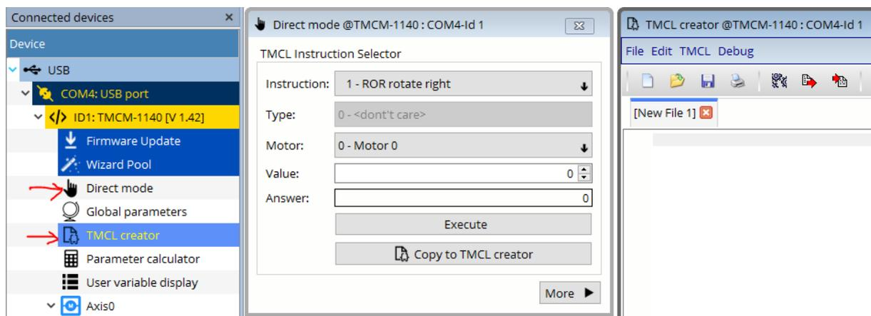
Dans "TMCL creator" cliquez sur le menu "TMCL" puis sur "Auto start mode" et cochez l'option "On...". Cela permet de lancer le programme de configuration ".tmc" à la mise sous tension de l'EZYACT.
