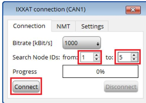
Si la connexion c'est bien établi alors TMCL-CANopen détecte l'ID CAN du module ainsi que le type de l'électronique de contrôle qui pilote le moteur de l'EZYACT.
