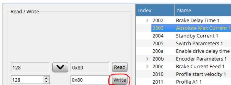
Le terminal permet d'avoir le détail de la commande brute envoyé sur le bus CAN:
