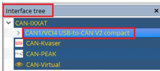
Utilisez les mêmes paramètres de communication CAN que ceux configurés dans le module EZYACT (configuration par USB avec fichier ".tmc"). Dans cette note d'application, nous utilisons une vitesse de 1 Mbps et un ID CAN = 1. Cliquez ensuite sur le bouton "Connect".
