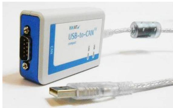
Connectez les signaux CAN\_H, CAN\_L et GND de l'adaptateur USB-to-CAN au connecteur JST "Power & Com" de l'EZYACT.
