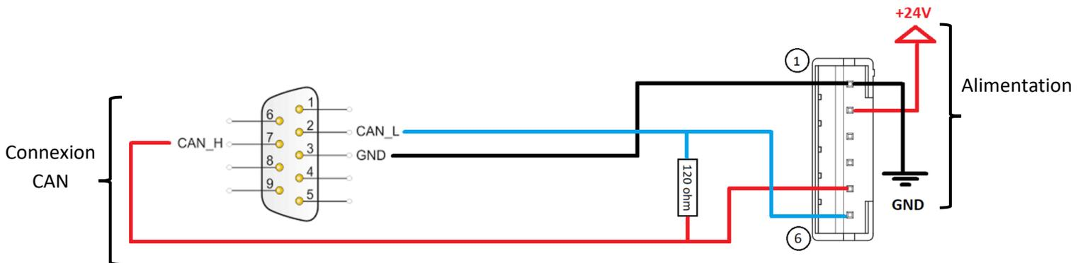
**Note :** Le bus CAN permet de contrôler le moteur en CANopen avec le protocole DS-402.
