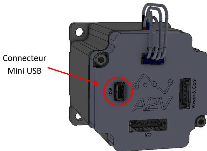
**Note :** La tension 5 Volt de la connexion USB suffit à alimenter l'électronique. Ceci permet de faire les configurations et des mises à jour firmware avec un branchement simple. Les configurations se font avec le logiciel TMCL-IDE de Trinamic.
