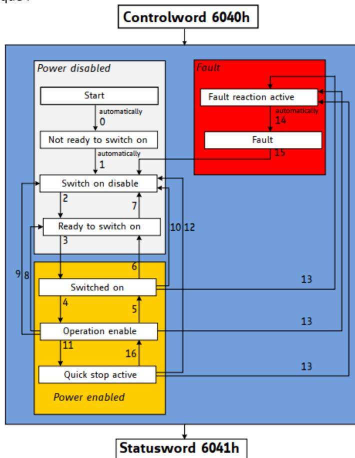
La modification de l'objet 6040h "Controlword" permettra d'ammener la machine d'état dans la bonne configuration pour réaliser un mouvement de positionnement.
