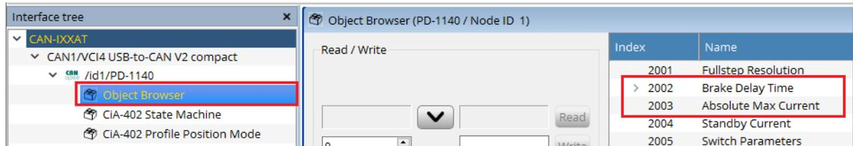
**2003h "Absolute Max Current"** : Cet objet définit le courant utilisé lorsque le moteur est en mouvement. Une valeur de 255 signifie 100% du courant maximum (soit 2 ampères RMS dans le cas de l'EZYACT-5740). La valeur par défaut est 128 (50% soit 1 Amp RMS).
