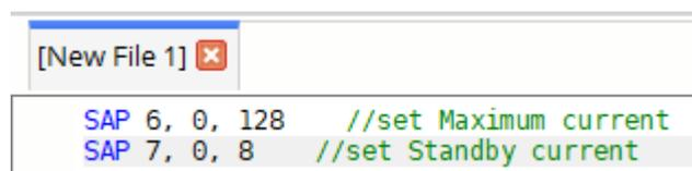
Le paramètre "**6 - Maximum current**" définit le courant utilisé lorsque le moteur est en mouvement. Une valeur de 255 signifie 100% du courant maximum (soit 2 ampères RMS dans le cas de l'EZYACT-5740). La valeur par défaut est 128 (50% soit 1 Amp RMS).
