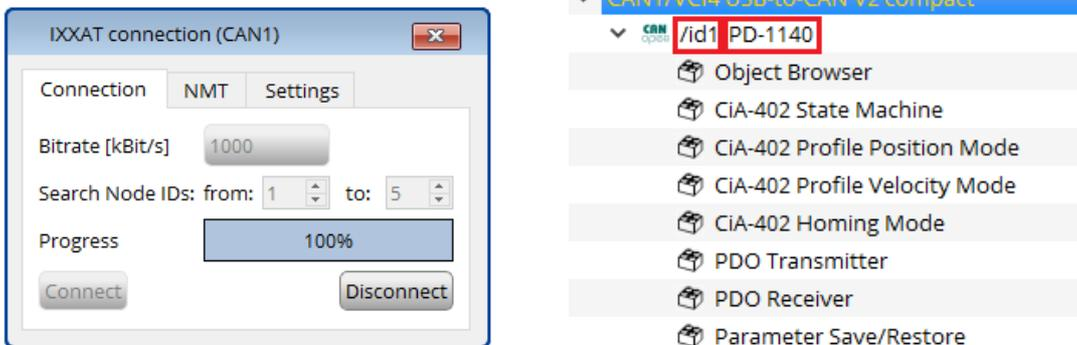
Vous pouvez également observer dans le terminal de TMCL-CANopen que le fichier ".eds" relatif à l'électronique de contrôle "PD-1140" c'est bien chargé. Cela permet de disposer de l'ensemble des objets CANopen qui peuvent piloter l'EZYACT-5740 :
